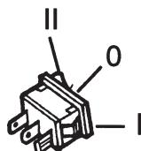
Переключатель отключен в положении "0", подает ток к подогреву ручки в положении "л", подает ток к подогреву карбюратора в положении "лл".
