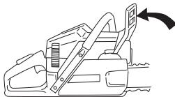
Отвинтите гайки крепления пильного полотна и снимите крышку муфты сцепления (тормоза цепи). Снимите транспортировочное кольцо (A).
