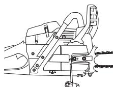
Цепь считается натянутой правильно, если она свободно проворачивается рукой. После этого , удерживая носок пильного полотна в верхнем положении, затяните гайки крепления пильного полотна универсальным ключом.
