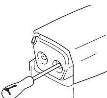
В некоторых глушителях предусмотрен специальный искрогаситель. Если ваша машина оборудована таким глушителем, сетку фильтра следует чистить раз в неделю. Наилучшие пользовательства стальной щеткой. Забитая решетка приводит к работе с горячим двигателем, что дает серьезные повреждения двигателя.
