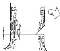
Вставьте зубчатый упор (если установлен) сзади надреза. Работайте на полном газу и вводите пильное полотно в ствол дерева постепенно, плавным движением. Следите за тем, чтобы дерево не начало перемещаться в
